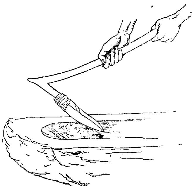
Рис. 8. Процесс работы желобчатым теслом.
