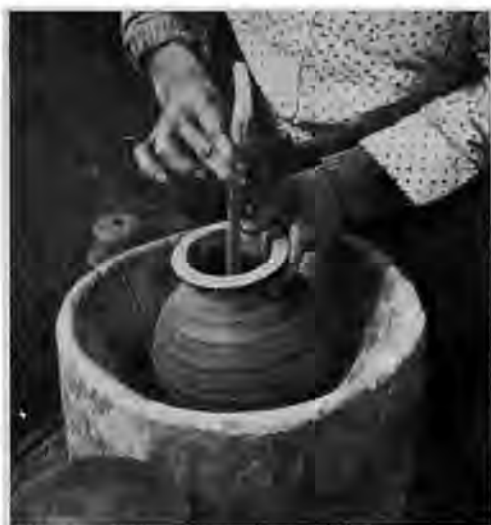
Рис. 4. Процесс выбивания донной части сосуда
